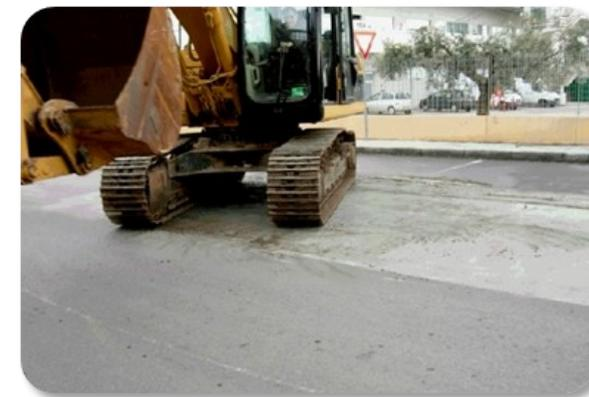
Test di usura della pavimentazione sottoposta ad azione di un escavatore cingolato.
